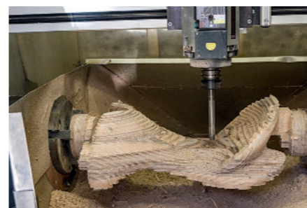
In der Equiscan-Werkstatt von Experte Christoph Rieser wird jeder Sattelbaum auf Maß aus einem Holzblock herausgefräst
