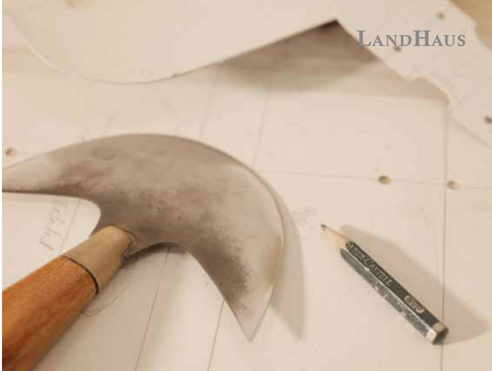
Die Schablonen für Sättel, Zaumzeug, Taschen und Accessoires werden aus Pappe gefertigt. Das extrem scharfe Halbmondmesser schneidet auch das dickste Leder
