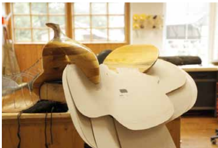
Mit den Daten, die die Vermessung (l.) liefert, wird der Sattelbaum gebaut. Schablonen zeigen, wie der Sitz später aussehen wird (r.)
